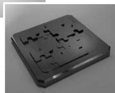
オール研削加工で 製作されたジグソー パズルのサンプル
