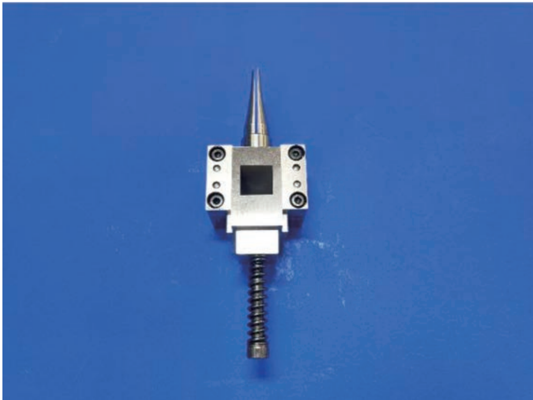
図 18 突き出し機構付きスライドコア
