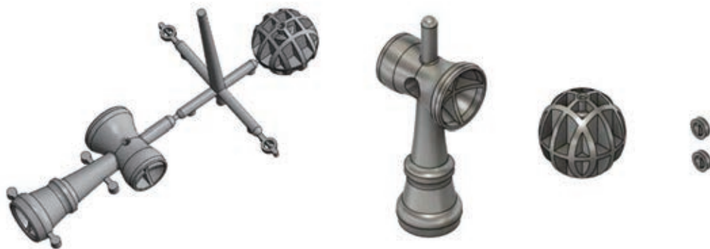
図 4 射出成形品 3D モデル（成形材料：PP 容積：14284.5 mm 3 ）／ 部品 3D モデル
