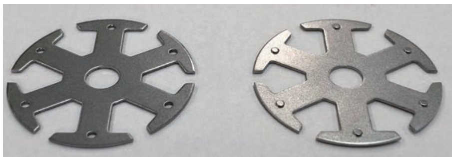
図4 プレス成型品 (カシメ前) 貫通 (左)、半抜き (右)
