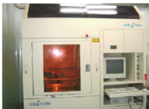
光造形装置●Soliform 500B 帝人製機 最大造形サイズ：500×500×500
