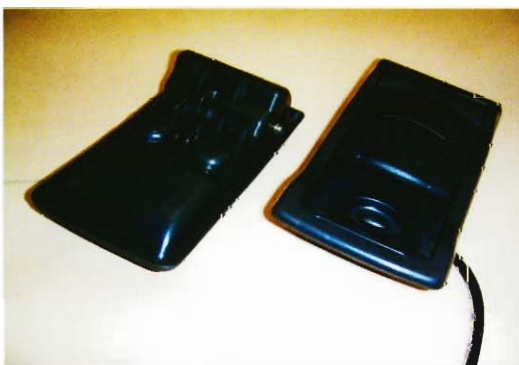
右の金型より180t射出成型機によるサンプル
