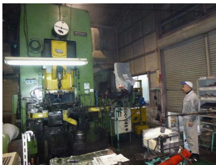
図表 48.イタリア・メコーラ社製 200t 全自動鍛造プレス機械
