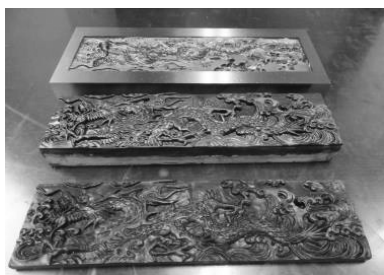
下から製品、電極 金型
