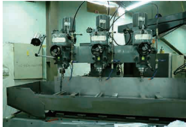
3頭ヘッドで3個のワークを同時加工
