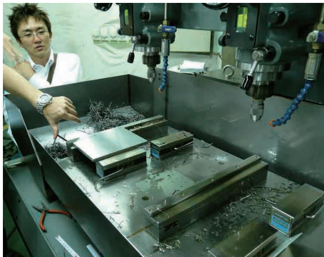
X軸は治具で位置決めをし、Y軸は芯だし作業が必要 クランプはマグネットで固定される
