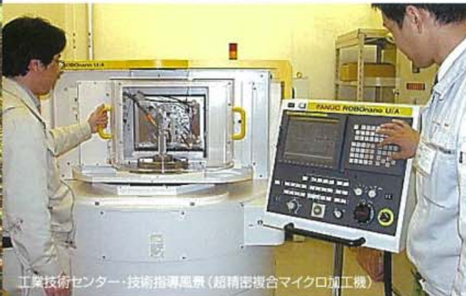
難加工材の曲面加工(光学ガラス<BK7>)
