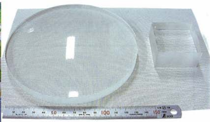
難加工材の曲面加工(光学ガラス<BK7>)
