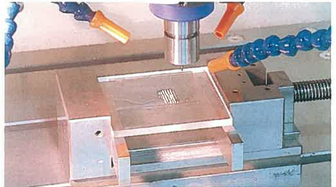
石英ガラスの微細穴加工φ0.1mm×深さ2mm(超精密加工テクノロジーセンター)
